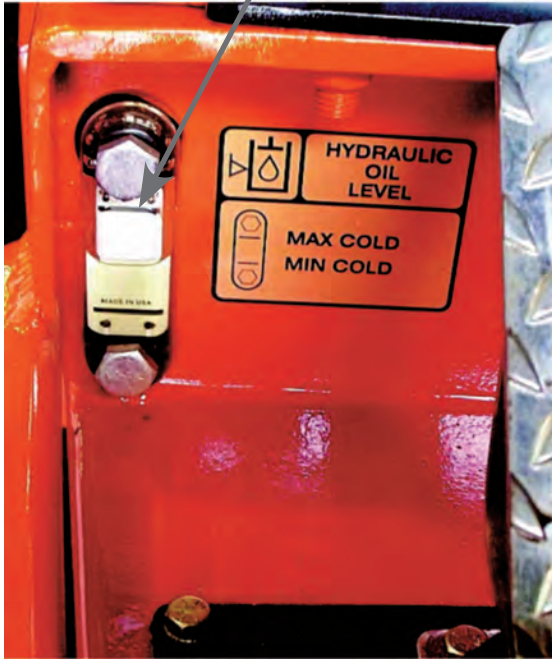
Nivel del fluido hidráulico
